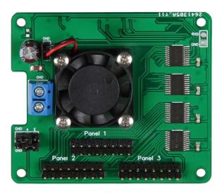
Stecken Sie zunächst das Matrix-Controllerboard auf die GPIO-Leiste Ihres Raspberry Pis auf. Verbinden Sie nun die HUB75-Stecker Ihrer Matrizen mit den entsprechenden Anschlüssen (Panel 1, Panel 2 & Panel 3) auf dem Controllerboard.
