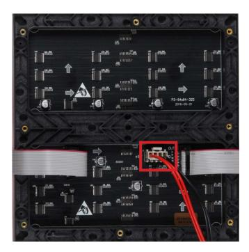
Mit Hilfe der 40-poligen GPIO-Leiste des Raspberry Pis lassen sich bis zu drei Matrizen parallel betreiben. Selbstverständlich können an jede Matrix noch weitere Matrizen in Reihe geschaltet werden. Bitte achten Sie hierbei darauf ihre Stromversorgung dementsprechend anzupassen.
