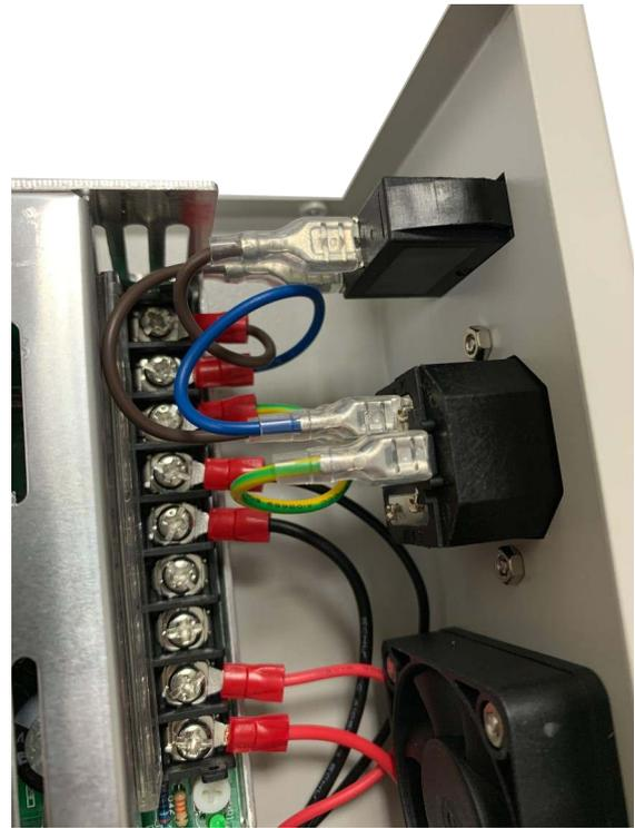
7. Nun verbinden Sie das schwarze Kabel der Lüftersteuerung und des Netzteils mit den dafür vorgesehenen Terminals V- und die roten Kabel mit den V+ Terminals.
