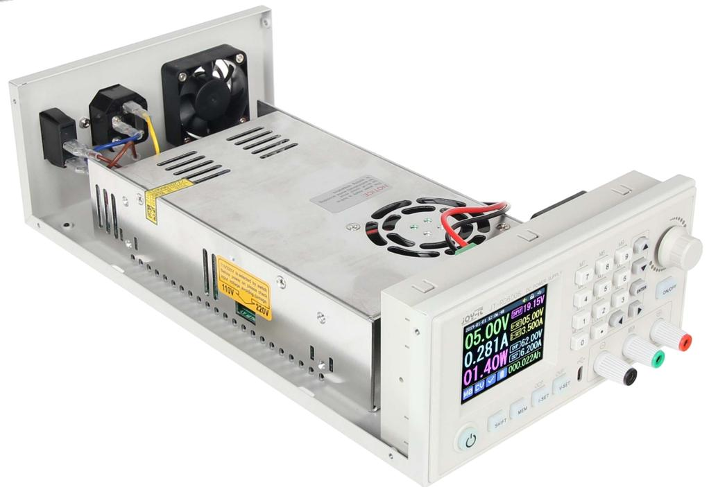
Sie können mit Hilfe eines Feineinstellpotenziometer die Ausgangsspannung am RD6006-NT eingestellt werden. Dies können Sie an der Eingangsspannung des RD6006 sehen. Idealerweise hat das RD6006 eine Eingangsspannung von 65 V, damit die vollen 60 V ausgegeben werden können.
