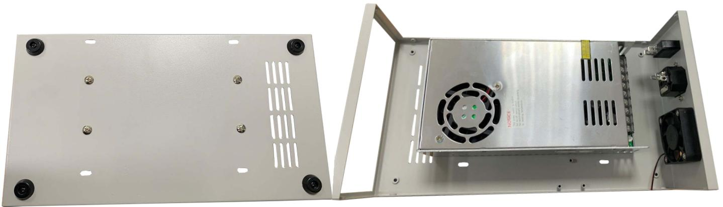
5. Nun schrauben Sie die Lüftersteuerung neben dem Labornetzteil mit den restlichen schwarzen Schrauben fest und schließen Sie den Lüfter in den dazu vorgesehenen Anschluss an.
