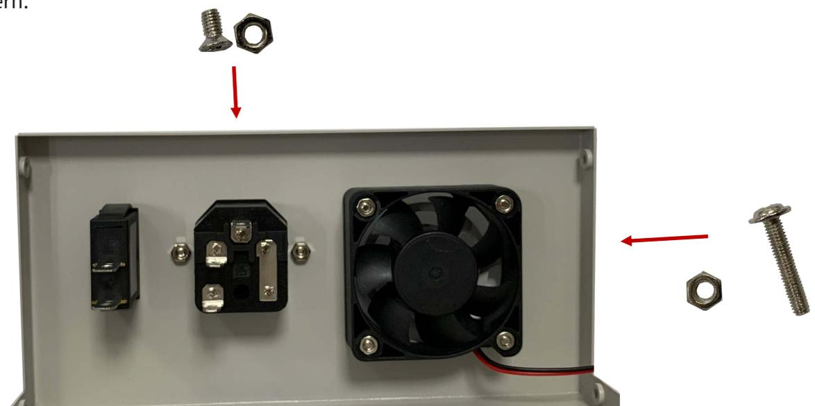
4. Setzen Sie nun das Netzteil in das Gehäuse ein und schrauben dieses mit den dicken silbernen Schrauben, vom Boden des Gehäuses aus, fest.
