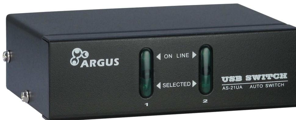
Der **KVM-AS-21UA** ist ein günstiger 2-Port KVM-Switch mit automatischem Audiuumschalter für den Desktopbereich.
