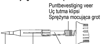
Soldeerpunt Hava Ucu Grot lutownicy Klemgroef Sıkıştırma vidası Szczelina zaciskowa Puntbevestiging veer Uç tutma klipsi Sprężyna mocująca grot Verwarmingselement Isıtıcı gövde Grzejnik
